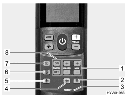
Bild 188 Fjärrstyrning med inställningsknappar (klimatanläggning)
