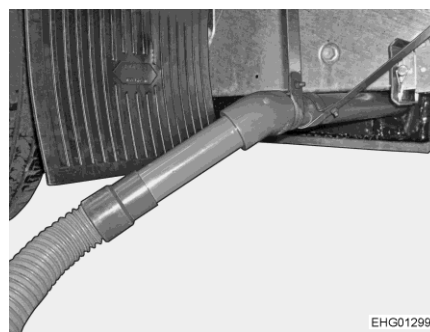
Bild 207 Avloppsrör med avloppsslang
