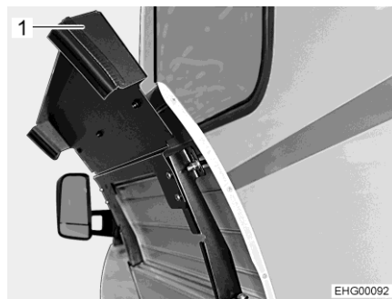
Bild 131 Gasbox (utvändig lucka öppen)
