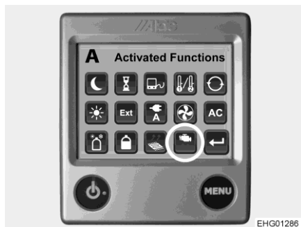
Bild 180 Funktion motorvärme (extra fläkt)
