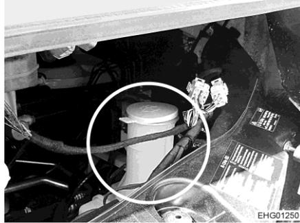
Fig. 40 Bec de remplissage (réservoir de liquide d'essuie-glace)
