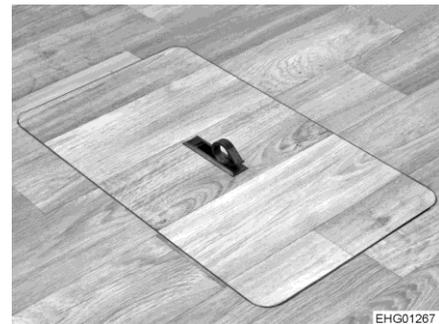
Fig. 83 Trappe de service (poignée sortie)
