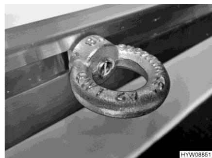
Fig. 7 Œillet de serrage (bloqué)
