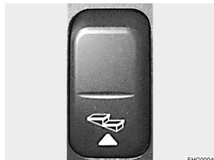
Fig. 10 Commutateur à bascule pour le marchepied (barrette de commutateurs)
