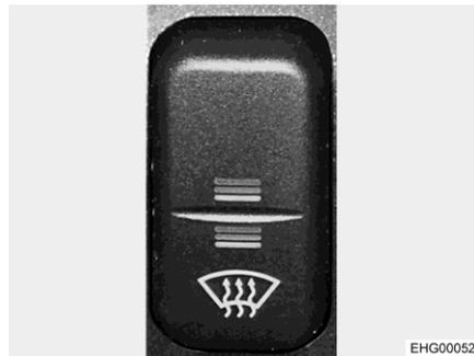
Fig. 11 Commutateur à bascule (chauffage du pare-brise)
