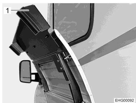
Fig. 131 Compartiment à gaz (portillon extérieur ouvert)
