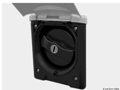
Fig. 202 Couvercle de fermeture (bec de remplissage d'eau potable)
