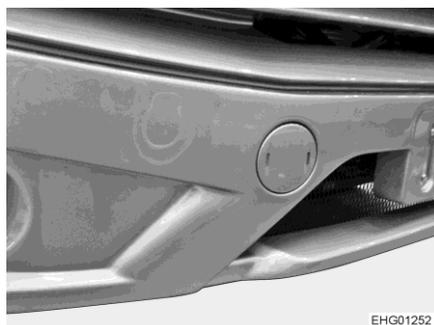
Fig. 43 Couvercle (fixation de l'œillet de remorquage)
