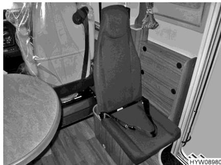
Fig. 30 Siège emboîtable déplié
