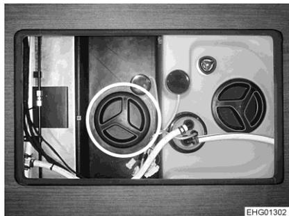
Fig. 220 Ouverture de nettoyage (réservoir d'eaux usées)
