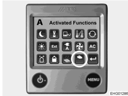
Fig. 180 Fonction chauffage du moteur (ventilateur d'appoint)
