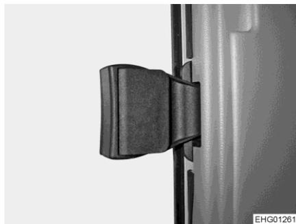
Fig. 62 Poignée d'ouverture de la fenêtre côté passager
