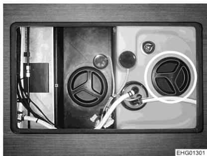
Fig. 219 Ouverture de nettoyage (réservoir d'eau)
