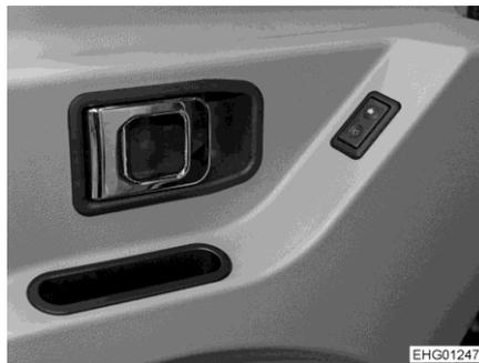
Fig. 34 Commutateur à bascule (lève-vitre électrique dans la porte chauffeur)
