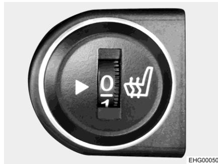
Fig. 23 Interrupteur du chauffage de siège
