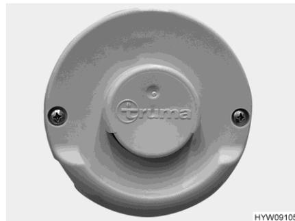
Fig. 185 Cheminée murale (chauffage à air chaud)
