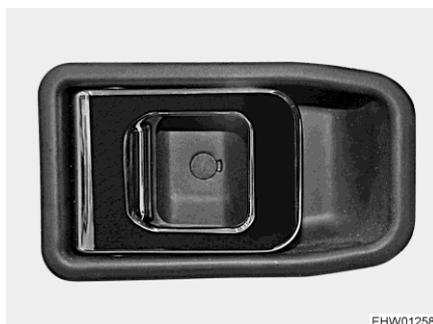
Fig. 56 Serrure de la porte (porte chauffeur, à l'intérieur)
