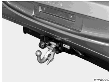
Fig. 8 Dispositif d'attelage (amo-vible)
