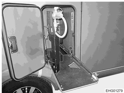
Fig. 130 Extension du compartiment à gaz en position de changement de bouteille
