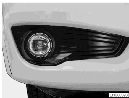
Fig. 231 Feu(x) de virages/projecteur antibrouillard
