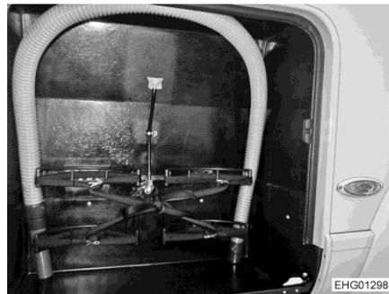
Fig. 206 Tuyau d'évacuation des eaux usées (compartiment à gaz)
