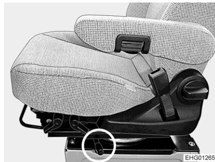
Fig. 81 Levier pour faire pivoter le siège
