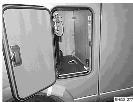
Fig. 128 Extension du compartiment à gaz
