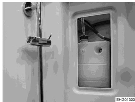
Fig. 222 Vase d'expansion (chauffage à eau chaude)
