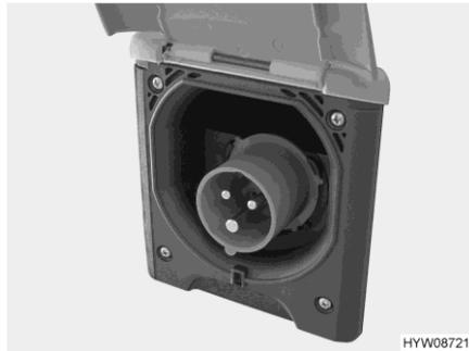
Fig. 147 Raccordement 230 V sur le véhicule (prise de courant CEE)
