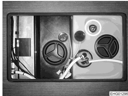
Fig. 203 Poignée tournante (vidange d'eau)
