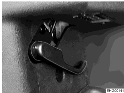
Fig. 38 Levier de déverrouillage du capot moteur
