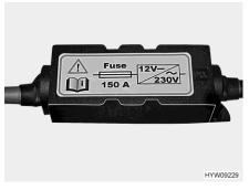
Fig. 152 Fuse (AC converter (150 A))
