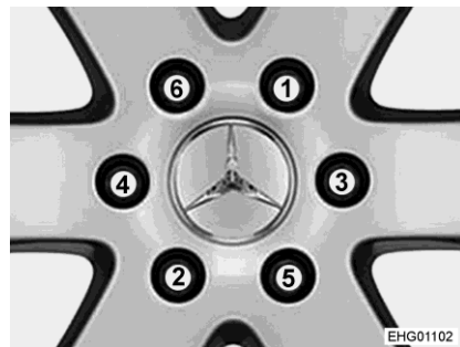
Bild 118 Radmuttern oder Radschrauben über Kreuz festziehen
