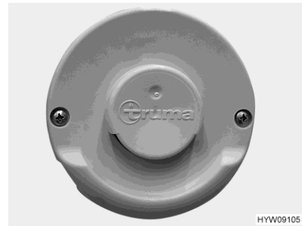
Fig. 174 Tubo de chimenea en la pared (calefacción de aire caliente)
