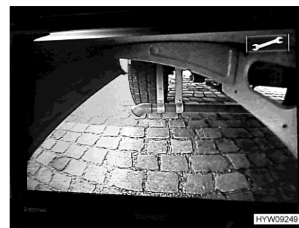
Fig. 34 Visualización de la cámara del depósito de aguas residuales (ejemplo)
