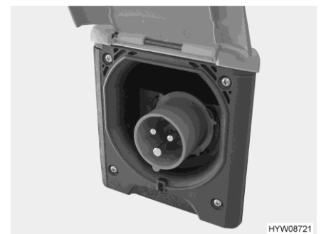
Fig. 138 Conexión de 230 V en el vehículo (caja de enchufe CEE)
