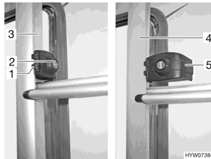
Fig. 2 Bloqueo (escalera trasera)
