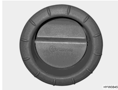
Fig. 151 Boquilla de salida de aire (calefacción de aire caliente)
