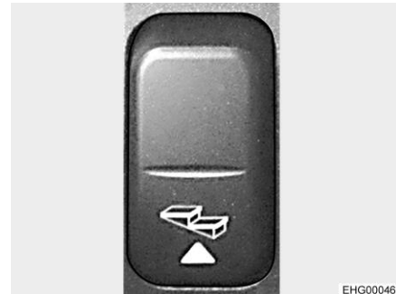
Bild 8 Wippschalter für Eintrittstufe (Schalterleiste)
