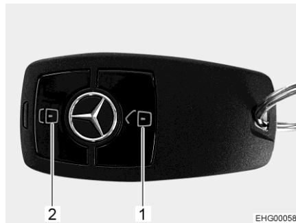
Rys. 50 Zdalne sterowanie (zamek centralny)
