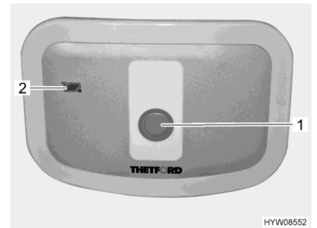
Rys. 218 Przycisk spłuczki/kontrolka (toaleta Thetford)
