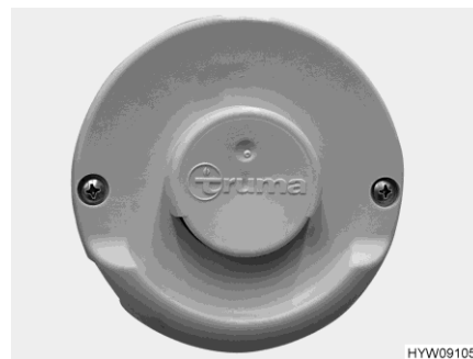
Rys. 190 Kominek ścienny (ogrzewanie powietrza)
