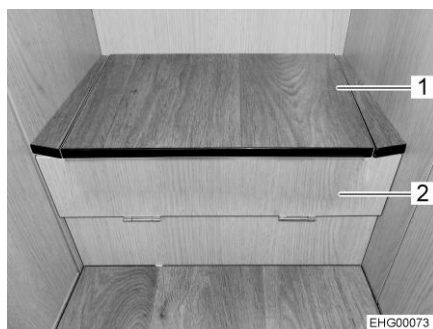
Rys. 121 Stopień do wchodzenia (zamknięty)
