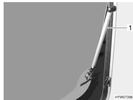
Rys. 62 Okna uchylne z automatycznymi teleskopami
