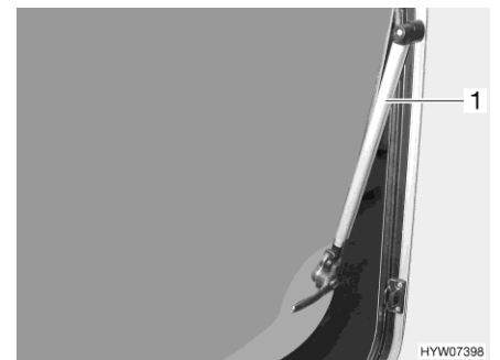
Bild 42 Överkantshängt fönster med automatik-spärr
