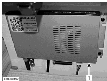
Bild 100 Styrenheten (TV-Satellitsystem, ten Haaft)
