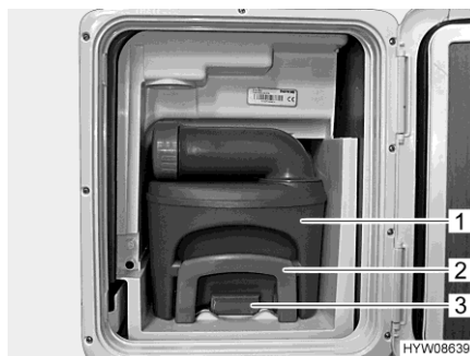
Rys. 214 Zbiornik na fekalia (w pojeździe)
