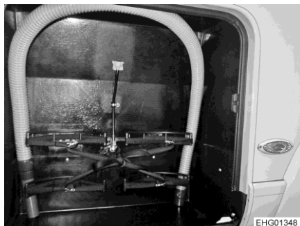
Rys. 208 Wąż odpływowy w skrzyni na butle gazowe
