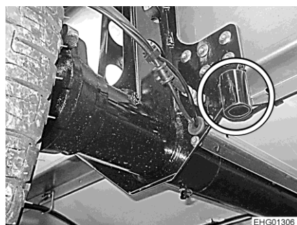
Rys. 241 Podparcie osi tylnej
