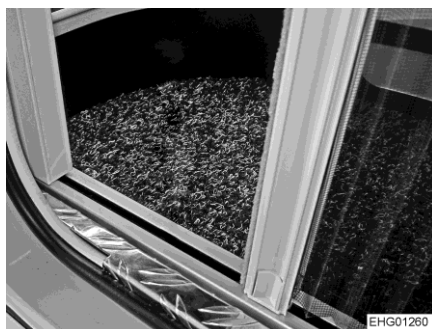
Rys. 57 Moskitiera (dolna prowadnica)
