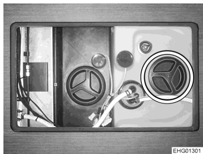
Fig. 219 Ouverture de nettoyage (réservoir d'eau)
