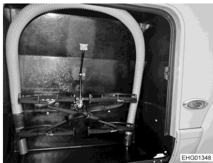
Fig. 208 Tuyau d'évacuation des eaux usées dans le compartiment à gaz
