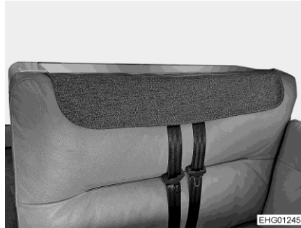
Fig. 13 Protection des ceintures de sécurité en place
