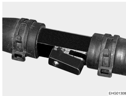
Fig. 174 Robinet d'arrêt (ouvert)
