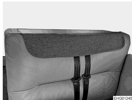
Fig. 92 Protection des ceintures de sécurité en place
