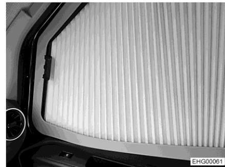
Bild 69 Faltverdunklung (Beifahrerfenster)
