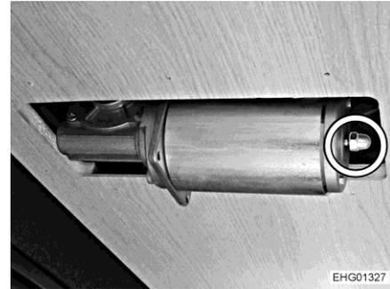
Bild 115 Hutmutter (Verstellmotor Bett)
