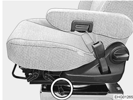
Bild 87 Hebel zum Drehen des Sitzes
