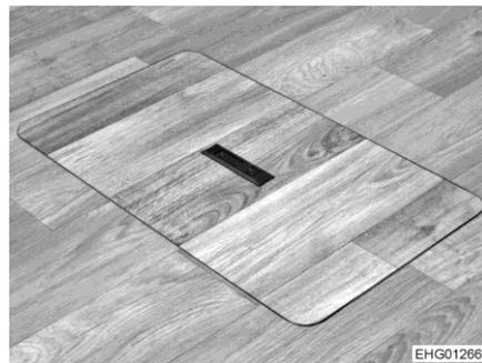
Bild 88 Service-Abdeckung (Griff versenkt)
