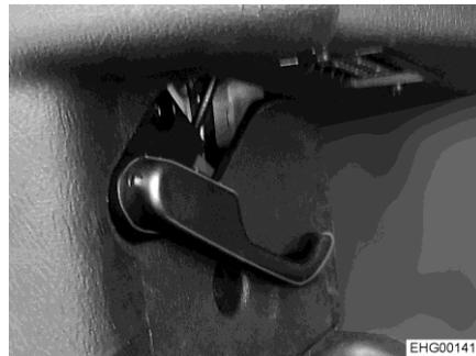
Bild 35 Entriegelungshebel Motorhaube
