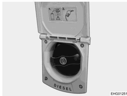
Bild 38 Kraftstoff-Einfüllstutzen
