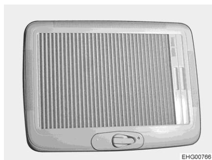
Bild 79 Dachhaube (Lamellenplissee geschlossen)
