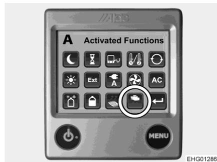
Bild 180 Funktion Motorheizung (Zusatzgebläse)
