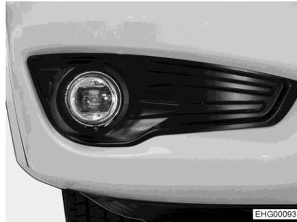
Bild 231 Kurvenlicht/Nebelscheinwerfer
