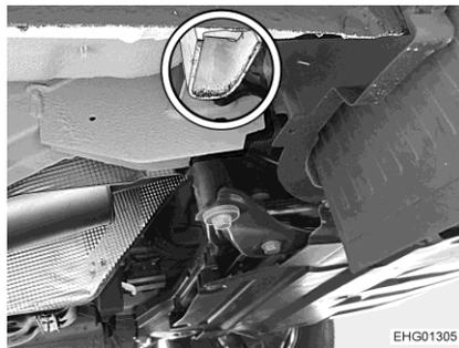
Bild 239 Aufnahme Vorderachse
