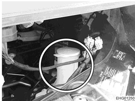
Bild 37 Einfüllstutzen (Waschwasserbehälter)
