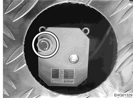
Bild 207 Handrad (Abwasserventil)
