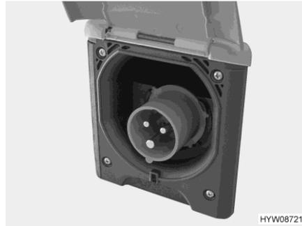
Bild 149 230-V-Anschluss am Fahrzeug (CEE-Steckdose)
