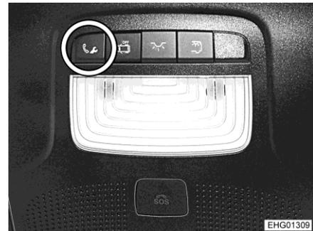
Bild 11 Taste für Pannenanruf (Dachkonsole)
