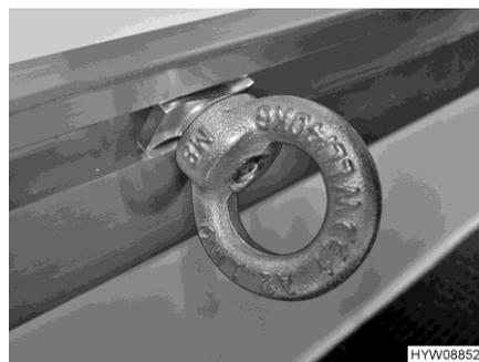
Bild 4 Verzurröse (verschiebbar)
