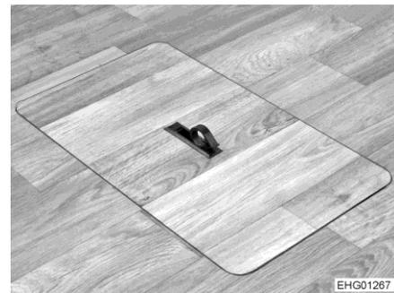
Bild 89 Service-Abdeckung (Griff herausgeschwenkt)
