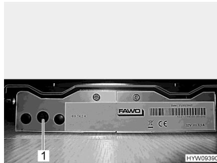
1 Glasrohrsicherung 4,0 A
