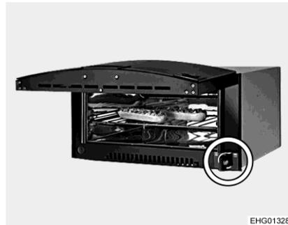
Bild 196 Drehregler am Gasbackofen (Dometic TecTower)
