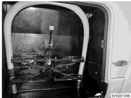
Bild 208 Abwasserschlauch im Gaskasten
