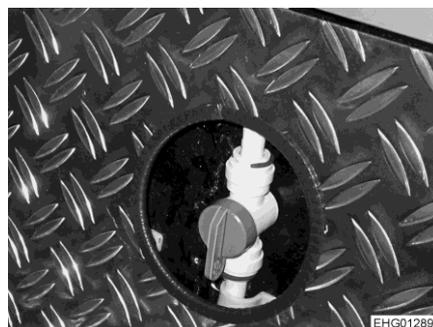
Bild 183 Vorlaufventile (Beheizung Heckstauraum)
