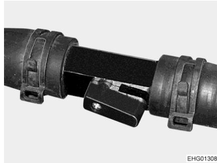
Bild 174 Absperrhahn (geöffnet)
