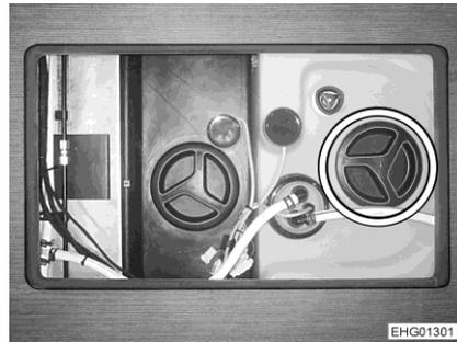
Bild 219 Reinigungsoffnung (Wassertank)
