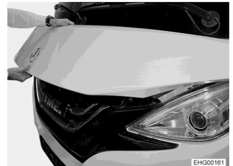
Bild 36 Korrekte Griffposition zum Öffnen der Motorhaube
