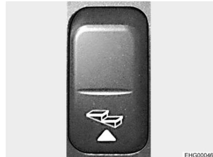
Bild 8 Wipptaster für Eintrittstufe (Schalterleiste)
