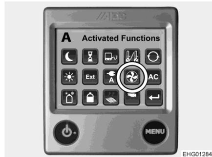
Bild 178 Booster-Funktion (Zusatzgebläse)
