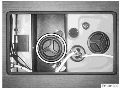
Bild 220 Reinigungsoffnung (Abwassertank)
