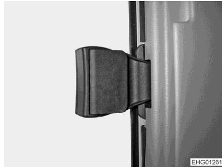
Bild 60 Griff zum Öffnen des Beifahrerfensters
