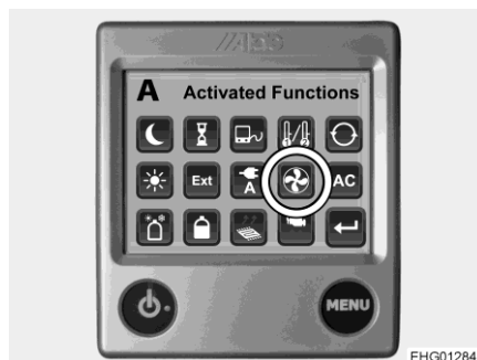
Bild 178 Booster-funktion (extra fläkt)
