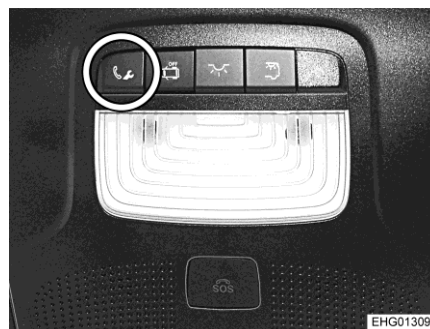
Bild 11 Knapp för samtal till vägassistans (takkonsol)
