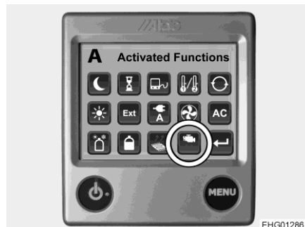
Bild 180 Funktion motorvärme (extra fläkt)
