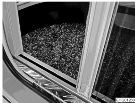
Bild 57 Insektsskydd (nedre ledning)
