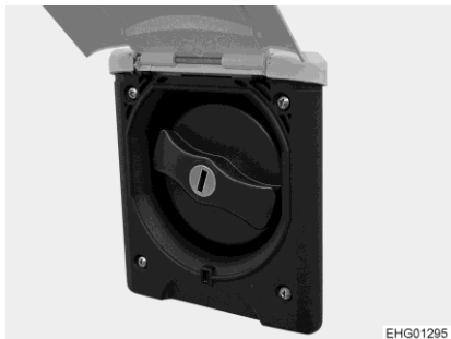
Bilde 203 Deksel (drikkevann-påfyllingsstuss)
