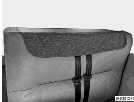
Bilde 92 Sikkerhetsbeltepanelet montert
