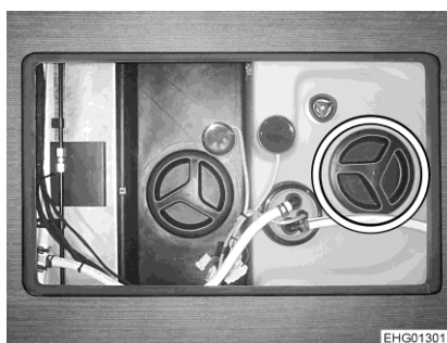
Bilde 219 Rengjøringsåpning (vanntank)
