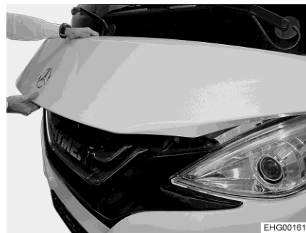
Bilde 36 Riktig håndtaksposisjon for åpning av motorlokket
