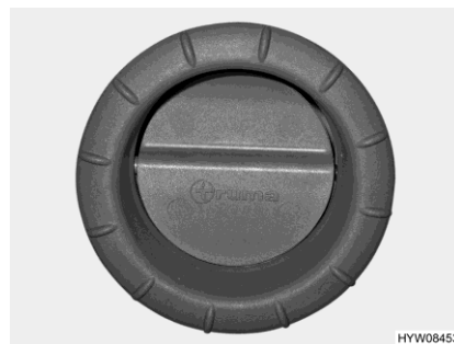
Bilde 162 Luftdyse (varmlufts-varmeanlegget)
