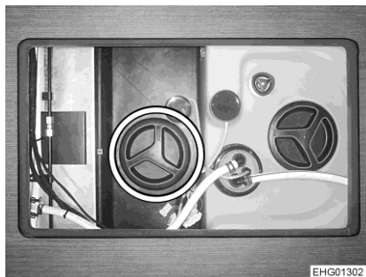
Bilde 220 Rengjøringsåpning (spillvannstank)
