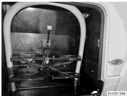
Bilde 208 Spillvannsslange i gasskapet
