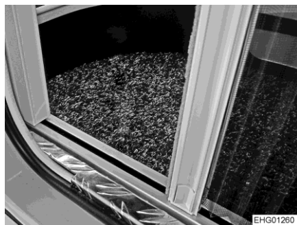
Obr. 38 Ochrana proti hmyzu (dolní vedení)
