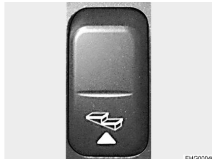
Obr. 11 Kolébkový spínač pro vstupní schody (spínací lišta)
