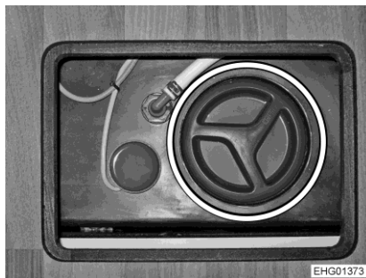
Obr. 162 Čisticí otvor (nádrž na odpadní vodu)
