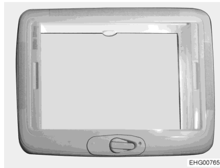
Obr. 50 Střešní poklop (zavřený)
