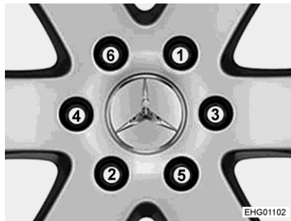
Bilde 118 Trekk til hjulmutrene eller hjulskruene over krysset
