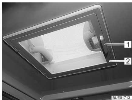
Bilde 27 Takluke med smekklås
