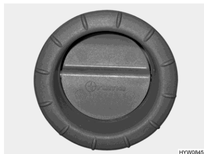
Bilde 84 Luftdyse (varmlufts-varmeanlegget)
