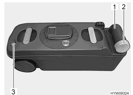
Bilde 165 Kloakktank (eksempel)
