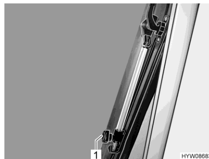
Bilde 39 Dreiearm (taklukevindu)
