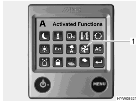
Bilde 124 Aktiverte funksjoner (tilleggsvisfe)
