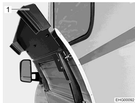
Kuva 117 Kaasupullokotelo (Ulkoluukku, auki)
