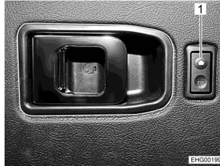
Kuva 29 Kytkin (kuljettajan ovessa oleva sähkökäyttöinen ikkunannostin)
