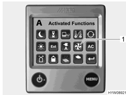
Kuva 165 Aktivoidut toiminnot (lisäpuhallin)
