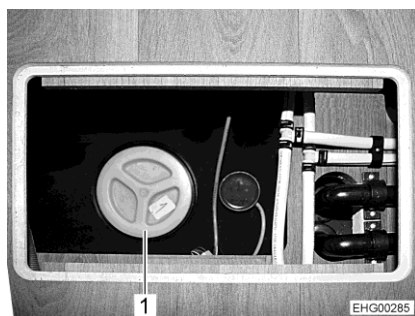
Fig. 117 Ouverture de nettoyage (réservoir d'eaux usées)
