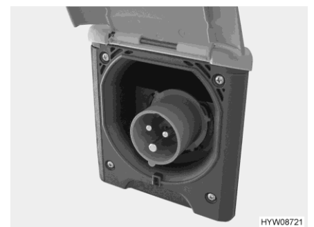
Fig. 77 Raccordement 230 V sur le véhicule (prise de courant CEE)
