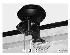
Fig. 50 Lock (ventilation position)
