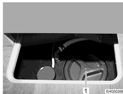
Rys. 155 Zbiornik na ścieki
