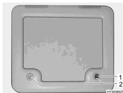
Rys. 148 Kłapa (zbiornik na fekalia)
