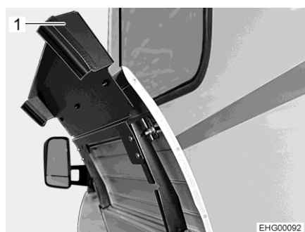
Bild 132 Gasbox (utvändig lucka öppen)
