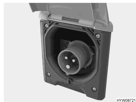
Fig. 151 Raccordement 230 V sur le véhicule (prise de courant CEE)
