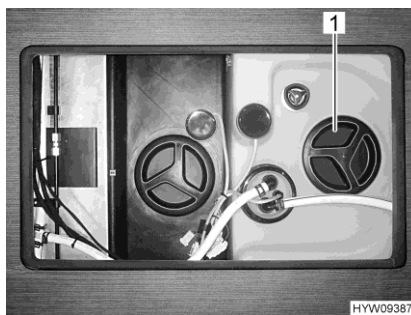
Fig. 220 Ouverture de nettoyage (réservoir d'eau)
