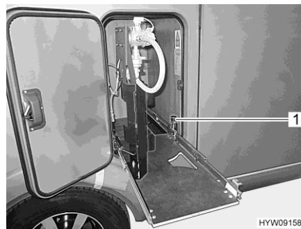
Fig. 131 Extension du compartiment à gaz en position de changement de bouteille
