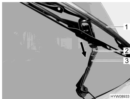
Fig. 226 Remplacer un balai d'essuie-glace
