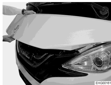
Fig. 39 Position correcte de la poignée pour ouvrir le capot moteur
