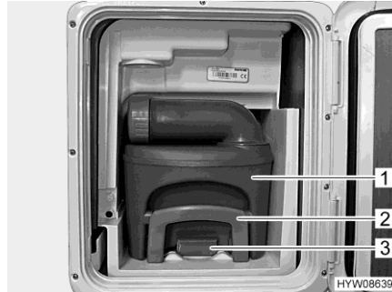
Bild 170 Latrintank (i fordonet)
