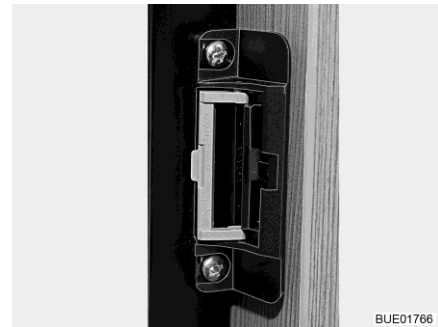
Bild 152 Låsanordning (ventilationsläge)
