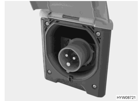
Kuva 97 230 V:n liitäntä ajoneuvolla (CEE-pistorasia)
