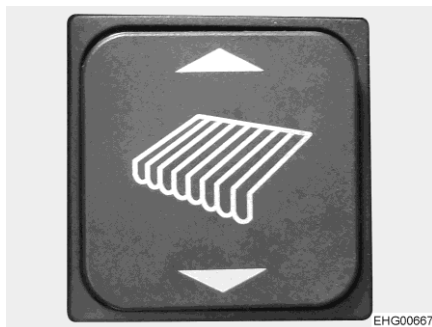
Fig. 48 Commutateur à bascule store extérieur (zone d'entrée)
