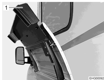
Fig. 134 Compartiment à gaz (portillon extérieur ouvert)
