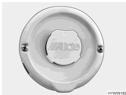
Fig. 189 Cheminée murale (chauffage à eau chaude)
