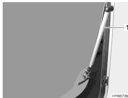
Fig. 62 Fenêtre projetante avec bras automatique
