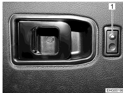
Rys. 31 Przełącznik (elektryczny podnośnik szyby okna w drzwiach kierowcy)
