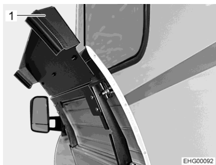
Rys. 134 Skrzynia na butle gazowe (zewnętrzna klapa otwarta)
