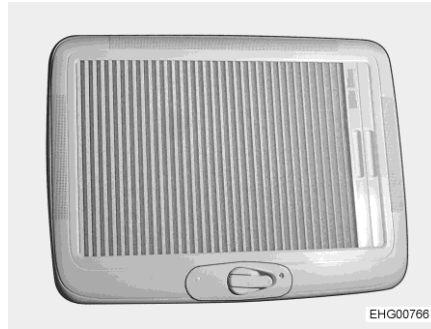
Rys. 79 Okno dachowe (plisa lamelkowa zamknięta)
