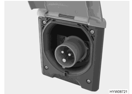
Rys. 153 Przyłącze 230 V w pojeździe (gniazdo CEE)
