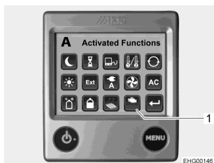
Rys. 185 Przycisk ekranowy podgrzewania silnika
