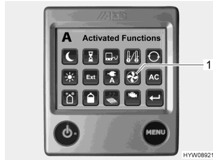
Fig. 178 Funzioni attivate (ventola aggiuntiva)
