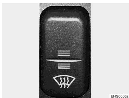
Fig. 11 Interruttore a bilico (riscaldamento del parabrezza)
