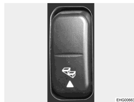
Obr. 5 Kolébkový spínač pro vstupní schody (přístrojová deska)
