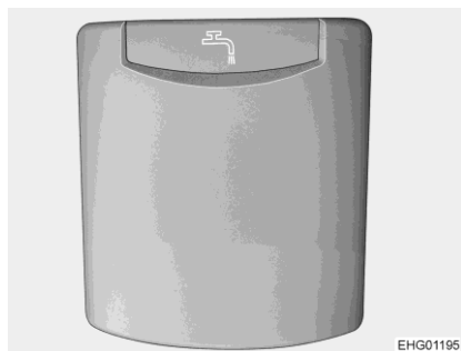
Obr. 124 Kryt plnicího hrdla pitné vody
