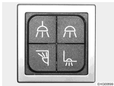
Obr. 88 Vícenásobný spínač světel (příklad)
