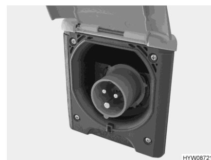
Bilde 71 230 V-tilkobling til kjøretøyet (CEE-stikkontakt)
