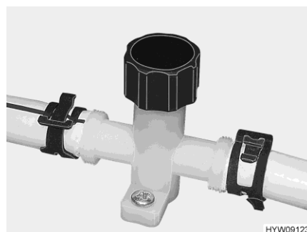
Bilde 104 Tappekran (vannledning)
