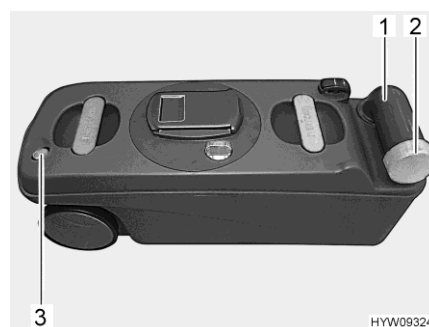
Fig. 114 Depósito de aguas fecales
