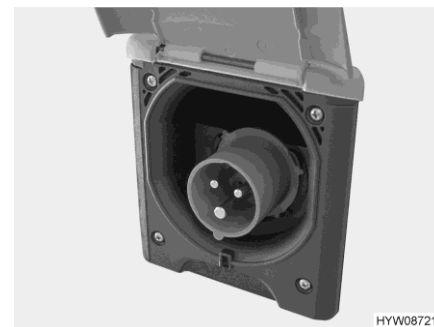
Fig. 75 Conexión de 230 V en el vehículo (caja de enchufe CEE)
