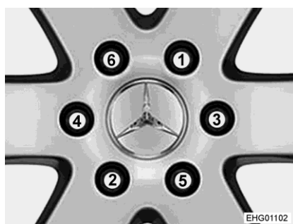
Fig. 118 Apretar las tuercas o los tornillos de las ruedas en forma de cruz
