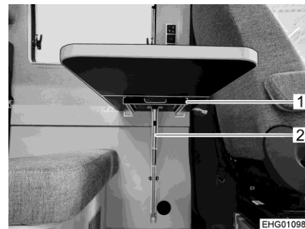
Fig. 47 Pie de apoyo (desbloqueado)
