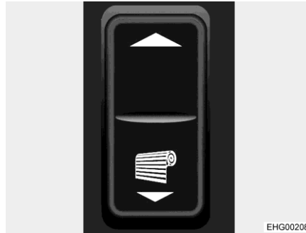
Bild 66 Wipptaster (Verdunklungsrollo/Sonnenblende)
