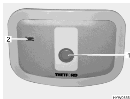
Rys. 167 Przycisk spłuczki/kontrolka (toaleta Thetford)
