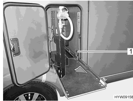
Afb. 85 Gaskast-uitschuifdeel in vervangingsstand
