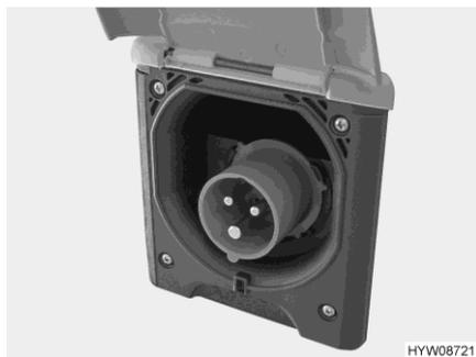
Fig. 149 Conexión de 230 V en el vehículo (caja de enchufe CEE)
