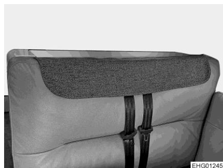
Fig. 92 Cubierta para cinturones de seguridad instalada
