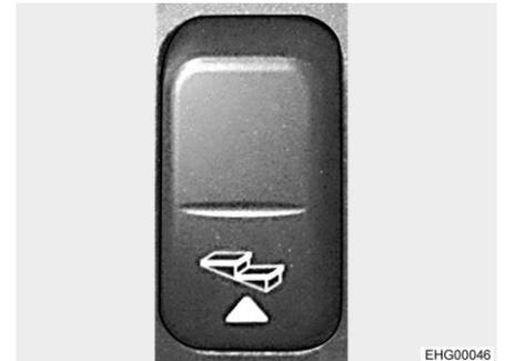
Fig. 8 Pulsador basculante para el escalón de entrada (panel de interruptores)
