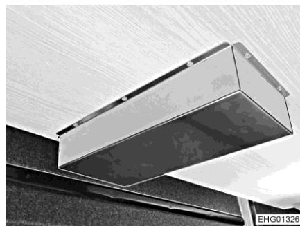
Fig. 114 Carcasa para el motor de ajuste
