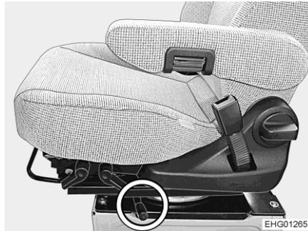
Fig. 87 Palanca para girar el asiento
