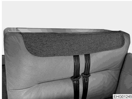
Fig. 13 Cubierta para cinturones de seguridad instalada
