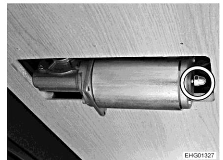
Fig. 115 Tuercas de sombrerete (motor de ajuste de la cama)
