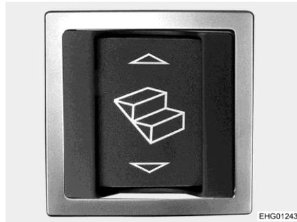
Fig. 7 Pulsador basculante para el escalón de entrada (zona de entrada)
