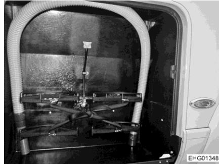
Fig. 208 Manguera de aguas residuales en la caja para bombonas de gas
