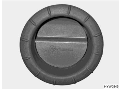
Fig. 162 Boquilla de salida de aire (calefacción de aire caliente)
