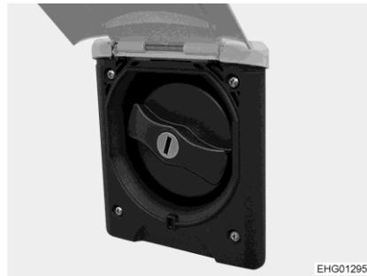
Fig. 203 Tapa de cierre (tubo de llenado de agua potable)
