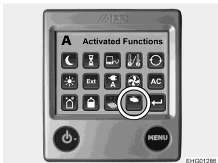
Fig. 180 Función Calefacción del motor (ventilador adicional)
