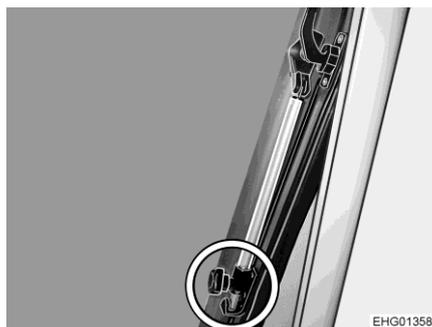
Fig. 65 Soporte rotatorio (ventana de techo abatible)
