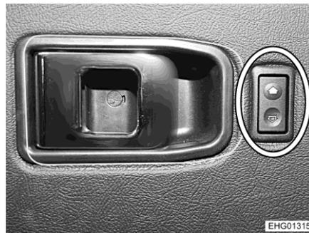
Fig. 31 Interruptor basculante (elevalunas eléctrico en la puerta del conductor)
