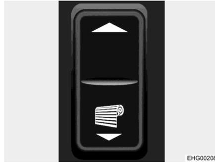
Fig. 71 Pulsador basculante (persiana oscurecedora enrollable/parasol)
