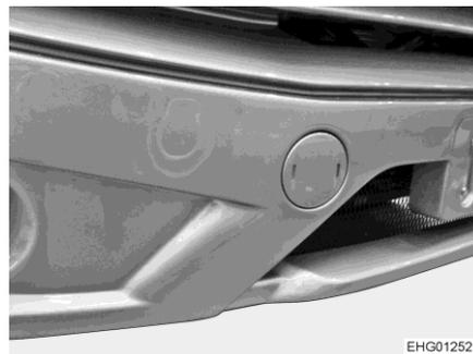
Fig. 40 Cubierta (alojamiento de la argolla de remolque)
