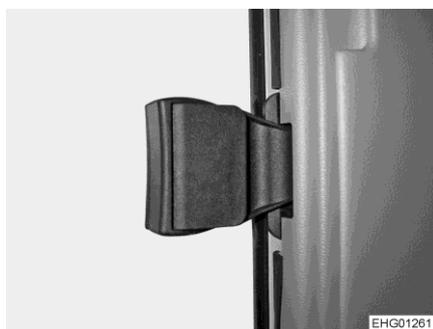
Fig. 60 Tirador para abrir la ventana del acompañante
