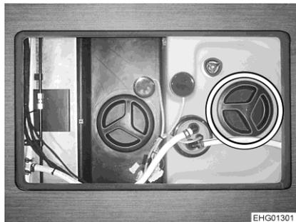
Fig. 219 Orificio de limpieza (depósito de agua)
