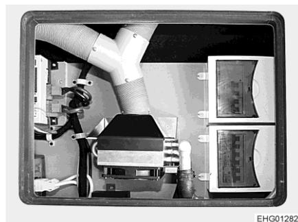
Fig. 176 Ventilador adicional con termocambiador (ejemplo)
