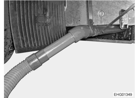
Fig. 209 Tubo de salida con manguera de aguas residuales
