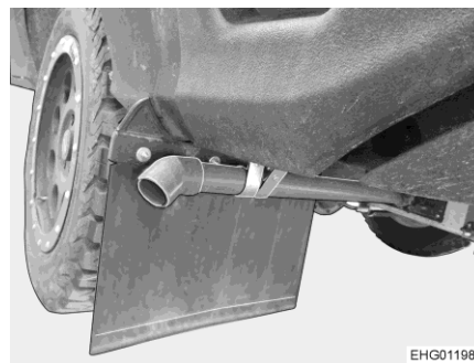
Fig. 128 Tuyau de purge
