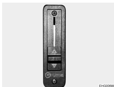
Fig. 115 Régulateur à coulisse pour la distribution d'air chaud dans le toit relevable
