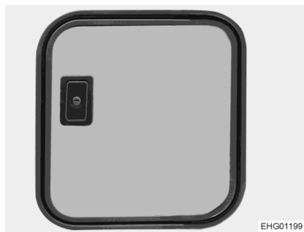
Fig. 140 Portillon (réservoir à matières fécales)
