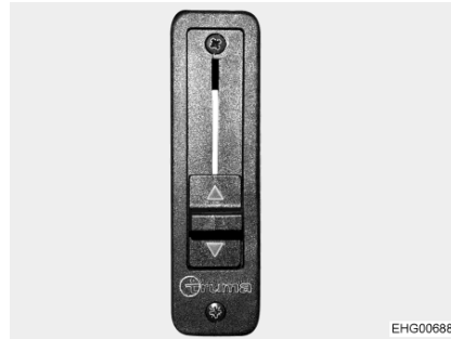
Fig. 119 Régulateur à coulisse pour la distribution d'air froid dans le toit relevable
