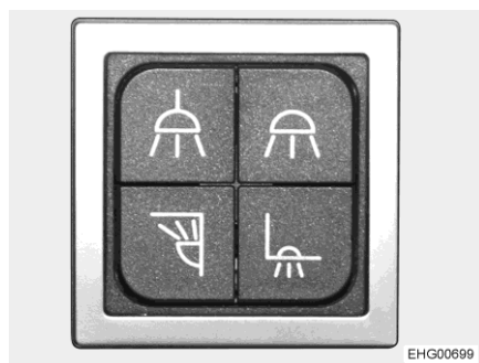
Fig. 88 Commutateurs multiples d'éclairage (exemple)
