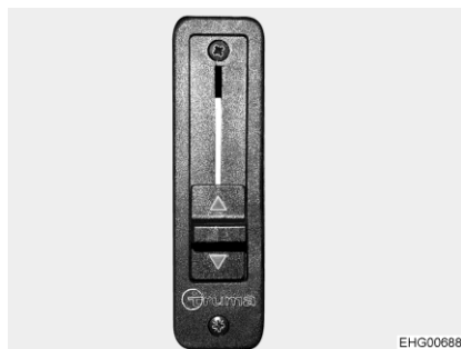
Rys. 119 Suwak rozdzielania zimnego powietrza w dachu sypialnym
