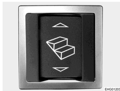
Rys. 4 Przelącznik kołyskowy do stopnia do wchodzenia (strefa wejścia)
