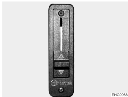
Rys. 115 Suwak rozdzielania ciepłego powietrza w dachu sypialnym
