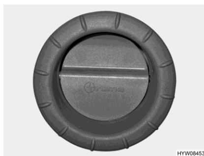
Rys. 109 Dysza wylotowa powietrza (ogrzewanie powietrza)
