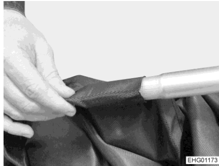
Rys. 27 Wprowadzić pręt poprzeczny w plandekę
