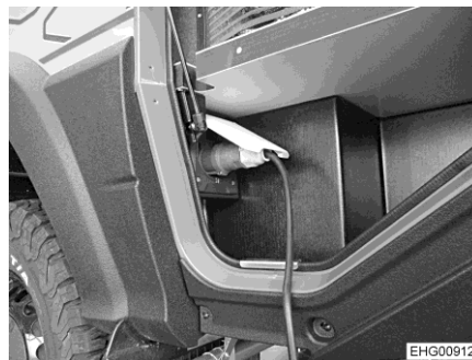
Rys. 105 Przyłącze 230 V w pojeździe (gniazdo CEE)
