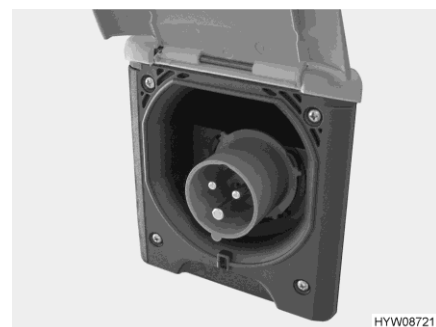
Afb. 71 230-V-aansluiting op het voertuig (CEE-contactdoos)
