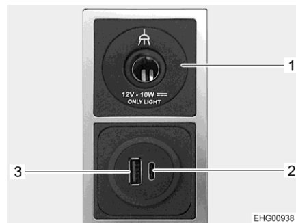
Kuva 76 Yhdistelmäpistorasia valaisimille ja USB:lle
