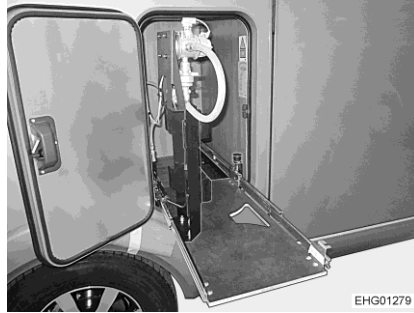
Kuva 93 Kaasupullokotelon alusta vaihtoasennossa
