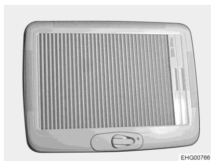
Kuva 52 Kattoluukku (lamelliverho suljettuna)
