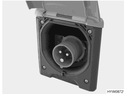
Kuva 107 230 V:n liitäntä ajoneuvolla (CEE-pistorasia)
