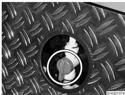
Fig. 132 Vanne de réglage (chauffage coffre arrière)
