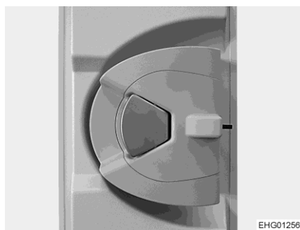
Fig. 35 Serrure de porte (porte cellule, à l'intérieur)
