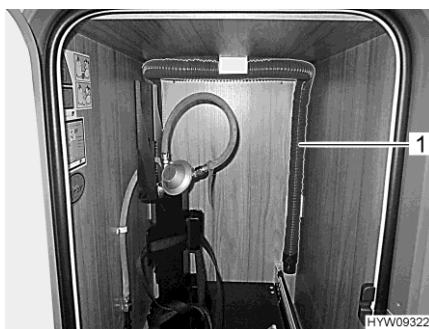
Fig. 147 Tuyau d'évacuation des eaux usées (extension du compartiment à gaz)
