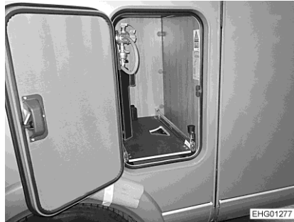
Fig. 91 Extension du compartiment à gaz
