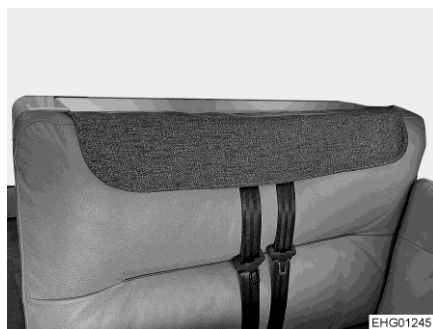
Fig. 17 Protection des ceintures de sécurité en place
