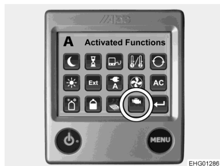
Fig. 125 Fonction chauffage du moteur (ventilateur d'appoint)
