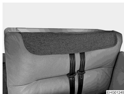
Fig. 64 Protection des ceintures de sécurité en place
