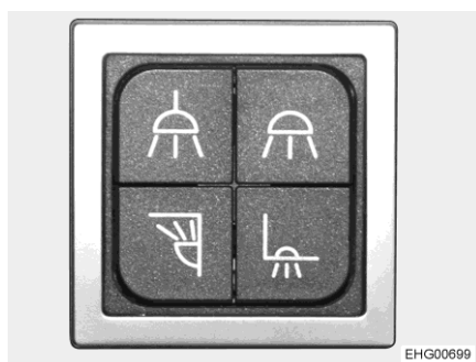
Fig. 74 Commutateur multiple d'éclairage
