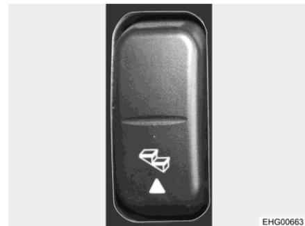
Fig. 5 Pulsador basculante para el escalón de entrada (salpicadero)
