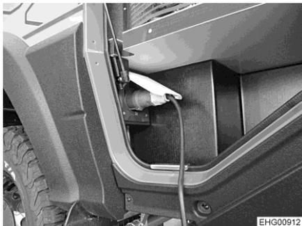
Fig. 105 Conexión de 230 V en el vehículo (caja de enchufe CEE)
