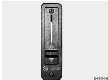
Fig. 119 Regulador de corredera para la distribución de aire frío en el techo elevable para dormir
