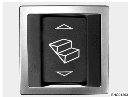
Fig. 4 Pulsador basculante para el escalón de entrada (zona de entrada)
