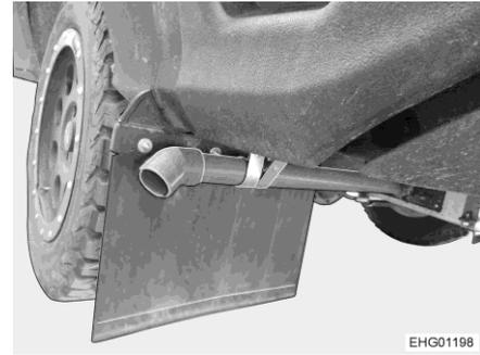
Fig. 128 Tubo de salida
