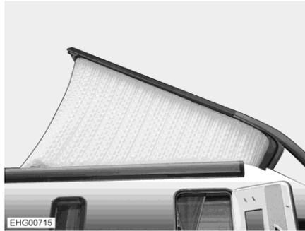
Fig. 39 Techo elevable para dormir, abierto
