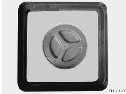
Fig. 144 Orificio de limpieza (depósito de aguas residuales)
