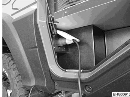
Fig. 17 Conexión de 230 V
