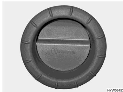
Fig. 109 Boquilla de salida de aire (calefacción de aire caliente)
