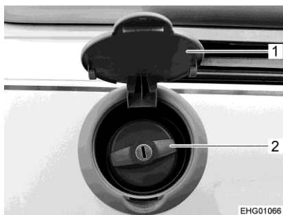
Bild 99 Påfyllningsöppning för dricksvatten
