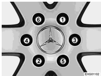
Bild 118 Dra fast hjulmuttrarna eller hjulbultarna korsvis
