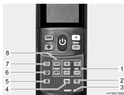
Fig. 177 Télécommande avec touches de réglage (climatisation)
