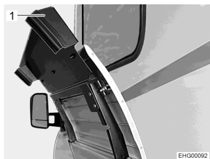
Fig. 120 Compartiment à gaz (portillon extérieur ouvert)
