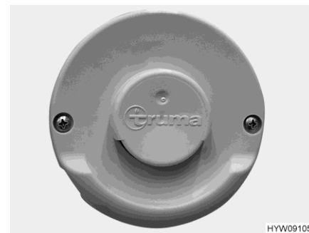
Fig. 174 Cheminée murale (chauffage à air chaud)
