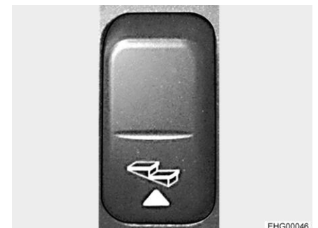
Obr. 7 Kolébkový spínač pro vstupní schody (přístrojová deska)
