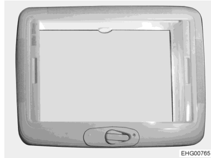
Obr. 31 Střešní poklop (zavřený)
