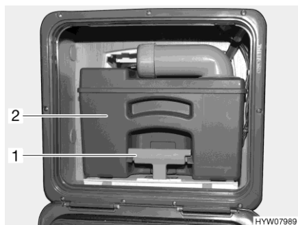
Obr. 129 Nádrž na fekálie (ve vozidle)
