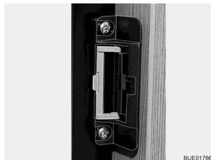
Obr. 152 Uzavírací zařízení (větrací poloha)
