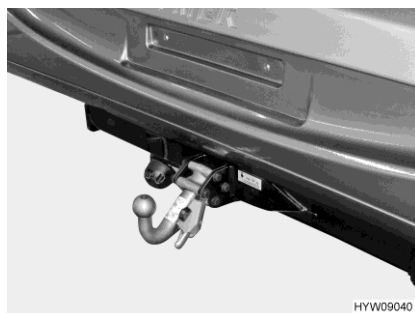
Obr. 8 Tažné zařízení (odnímatelné)
