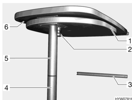
Obr. 67 Závěsný stůl s rozebíratelnou opěrnou nohou
