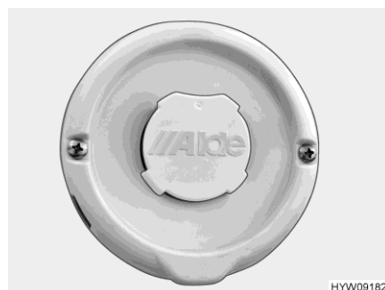
Obr. 131 Nástěnný komín (teplovodní topení)
