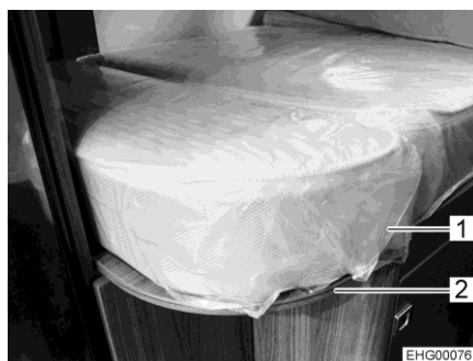
Obr. 81 Prodloužení ložné plochy s přídatným čalouněním
