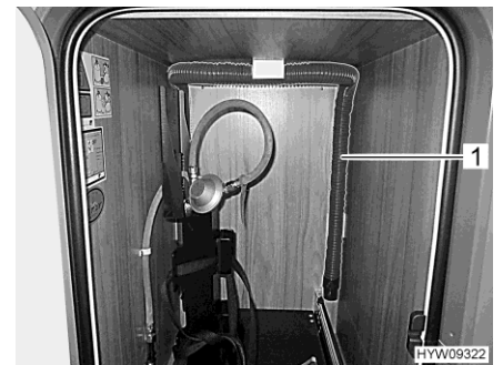
Obr. 160 Hadice odpadní vody (zásuvka plynové skříně)
