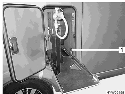
Obr. 91 Zásuvka plynové skříně ve výměnné poloze
