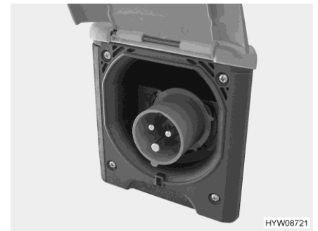
Obr. 107 Přípojka 230 V na vozidle (zásuvka CEE)
