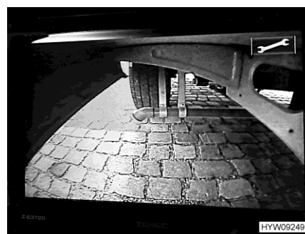
Obr. 24 Obraz kamery nádrže na odpadní vodu (příklad)
