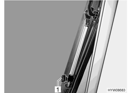
Obr. 42 Otočný vyklápěcí mechanismus (okno ve střešním poklopu)
