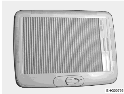
Obr. 49 Střešní poklop (lamelové plisé zavřené)
