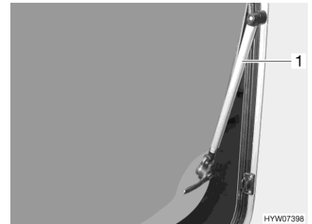
Obr. 39 Vyklápěcí okno s automatickým vyklápěcím mechanismem
