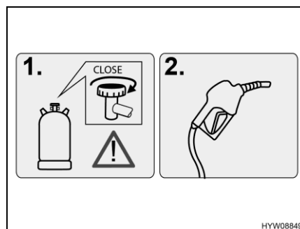
Obr. 25 Výstražné upozornění (plnicí hrdlo palivové nádrže)
