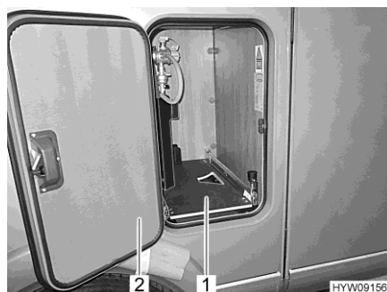
Bild 91 Utdragsdel till gasbox
