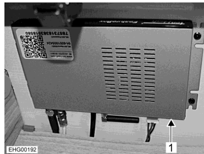
Bild 110 Styrenheten (TV-satellitsystem, ten Haaft)
