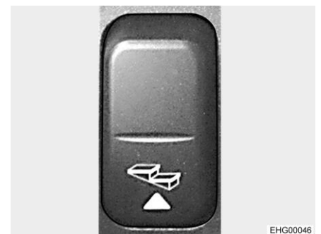
Bild 10 Vippkontakt för fotsteg (instrumentbrädan)
