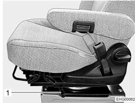
Bild 58 Spak (vridning av stolen) (Aguti GIS-Liner)
