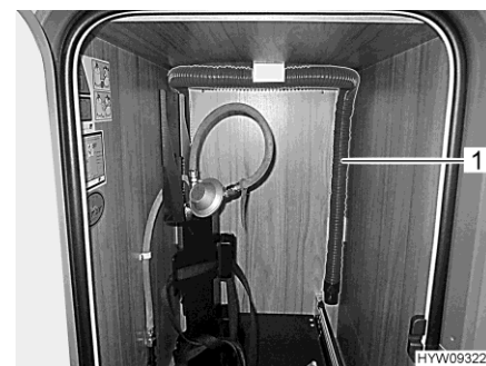
Bild 143 Avloppsslang (utdragsdel till gasbox)
