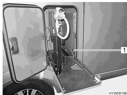
Bild 93 Utdragsdelen till gasboxen i bytesläge
