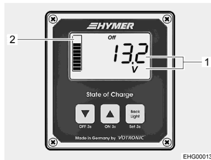
Bild 103 Indikatorpanel (visning av batterispänning)
