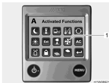
Fig. 178 Funciones activadas (ventilador adicional)
