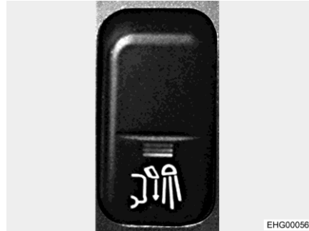
Fig. 45 Interruptor basculante (iluminación de la zona posterior)
