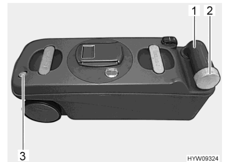
Fig. 216 Depósito de aguas fecales
