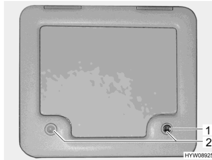
Fig. 214 Trampilla (depósito de aguas fecales)
