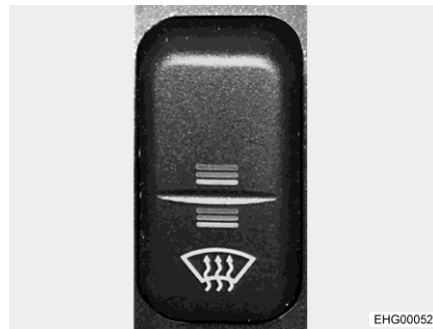
Fig. 11 Interruptor basculante (calefacción de la luna delantera)
