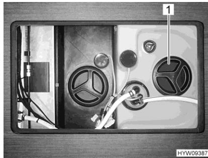
Fig. 220 Orificio de limpieza (depósito de agua)
