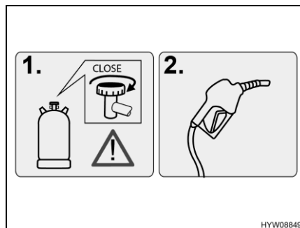
Kuva 13 Varoitus (polttoaineen täyttöaukko)
