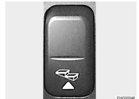
Afb. 10 Wipschakelaar voor opstap (dashboard)
