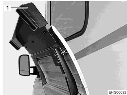
Fig. 132 Compartiment à gaz (portillon extérieur ouvert)
