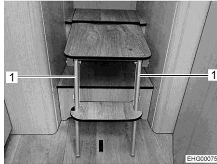
Fig. 118 Échelle de montée (dépliée)
