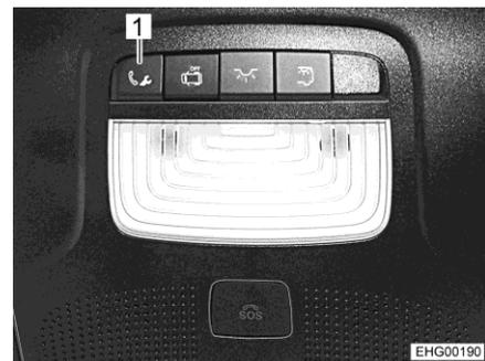
Fig. 14 Touche de demande de dépannage (console du toit)
