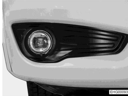
Fig. 232 Feu(x) de virages/projecteur antibrouillard
