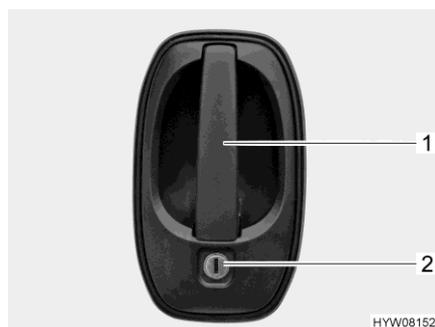
Fig. 55 Serrure de la porte (porte chauffeur, extérieur)
