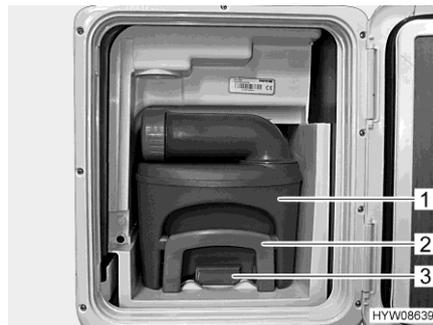
Fig. 215 Réservoir pour matières fécales (dans le véhicule)
