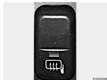
Fig. 34 Commutateur (chauffage du rétroviseur)
