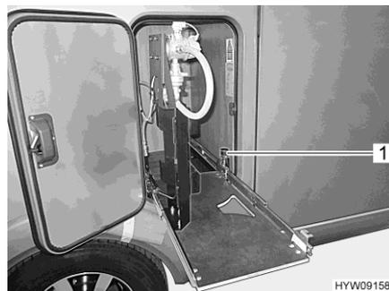
Fig. 131 Extension du compartiment à gaz en position de changement de bouteille
