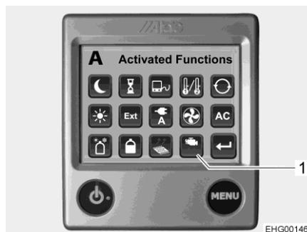
Fig. 180 Bouton chauffage du moteur
