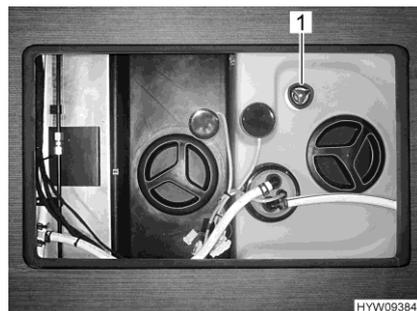
Fig. 205 Poignée tournante (réservoir d'eau)
