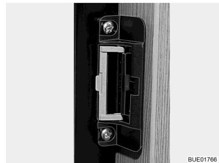
Fig. 199 Dispositif de fermeture (position de ventilation)
