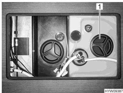
Fig. 220 Ouverture de nettoyage (réservoir d'eau)
