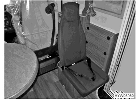
Fig. 28 Siège emboîtable (ouvert)
