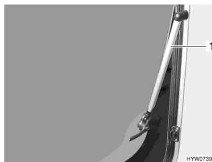
Fig. 64 Fenêtre projetante avec bras automatique
